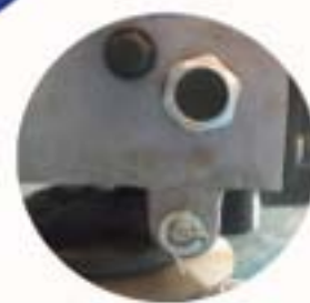
Caixa de redução com visor de nível de óleo
